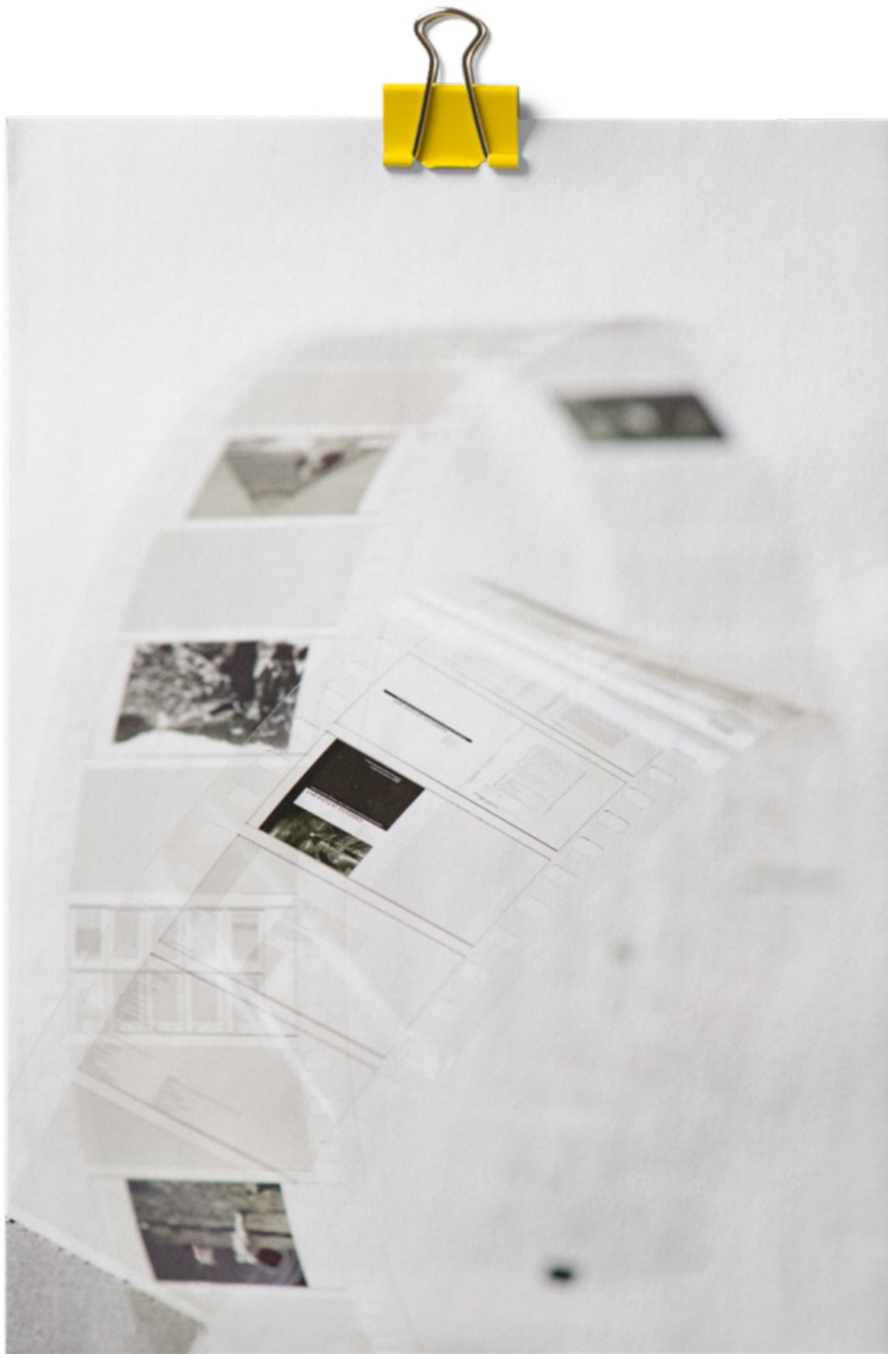
Filmformat som kan bevara digital information i minst 1 000 år. Förutom QR-kod går det att skriva läsbar text och bild direkt på filmen. Källa: Piql AS
